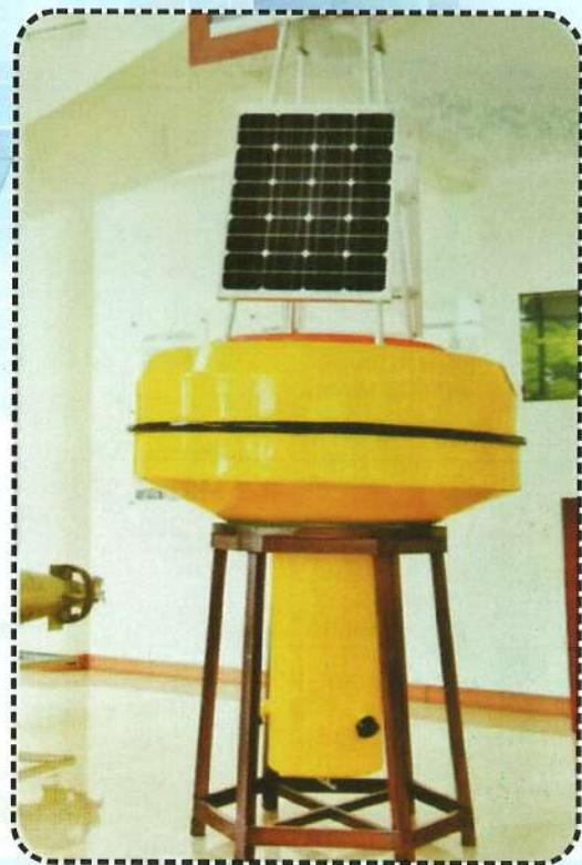
Sistem buoy dapat melakukan pendektsian jarak jauh secara terus-menerus, mengklasifikasi dan menentukan posisi kapal selam
