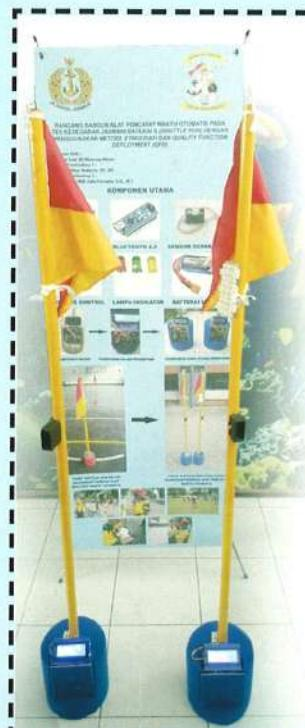
Alat pencatat waktu otomatis ditanam di pondasi tiang. Pergerakan lari peserta tes akan dideteksi oleh arduino nano. Selanjutnya hasil pengolahan data arduino nano dikirim ke PC melalui bluetooth.
