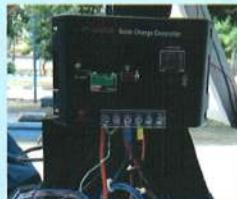
Suatu alat control yang berfungsi untuk mengatur tegangan dan arus yang dikeluarkan dari modul surya
