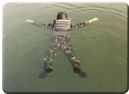
**Gambar 1. Pengujian Fugsi Apung Prototype dan Lampu Emergency saat laut gelap dan hujan**
