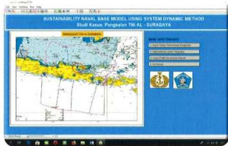
Gambar 1. Interface Model Software Program System Dynamic 9.1.3 untuk mengukur nilai Sustainabilitas atau Keberlanjutan Pangkalan TNI AL dari Aspek Teknis, Ekonomi dan Politik
