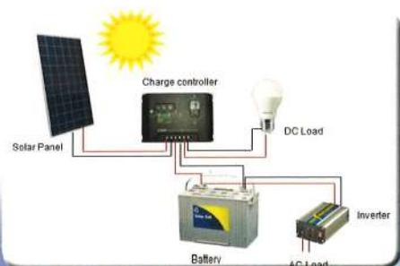
Gambar 1. Rangkaian minimum Pembangkit Listrik Tenaga Surya (PLTS)
