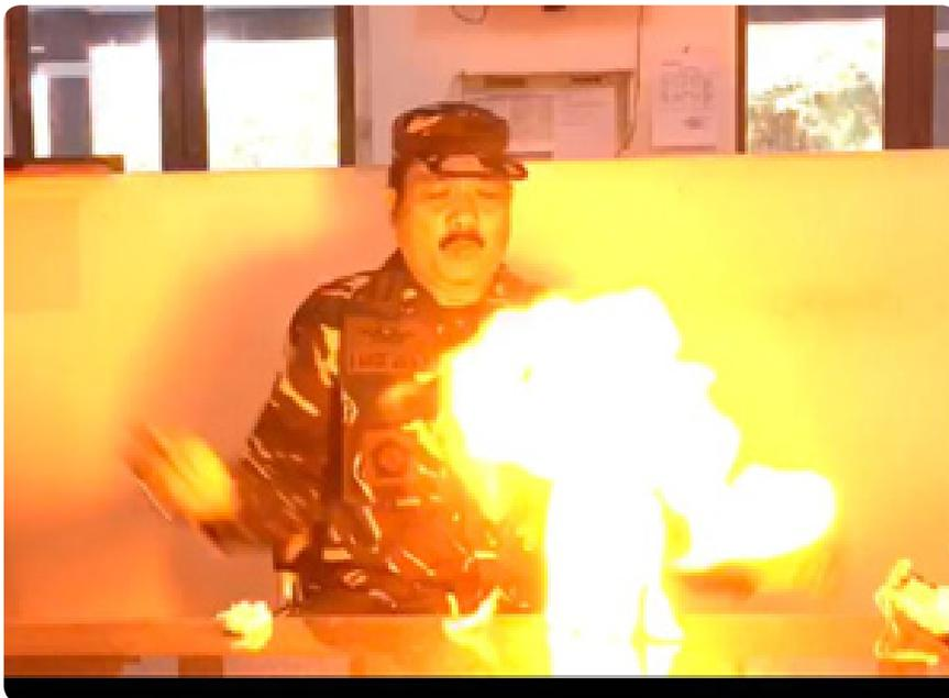
**Gambar 2.** Hasil uji bakar Nitroselulosa memiliki karakteristik dengan standar NC (Nitroselulosa)
