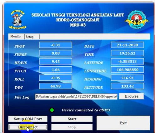
Gambar 4. GUI Menggunakan Delphi
