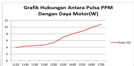
Gambar 3. Hasil pengujian tanpa beban
